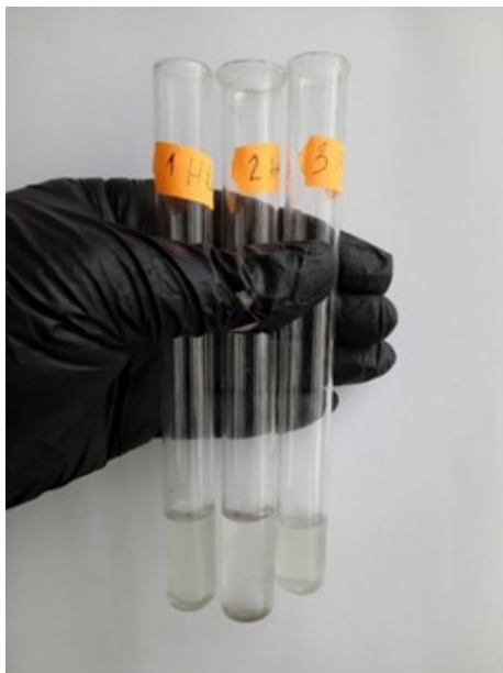
Рис.2.2. Дія групових індикаторів на досліджуваний розчин (1- HCl, 2- NaOH, 3- H 2 SO 4 )
