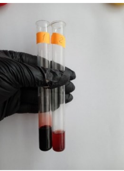
Рис.2.4. Дія амоній роданіду NH 4 CNS (пробірка №1 FeCl 3 , пробірка №2 – досліджуваний розчин)
