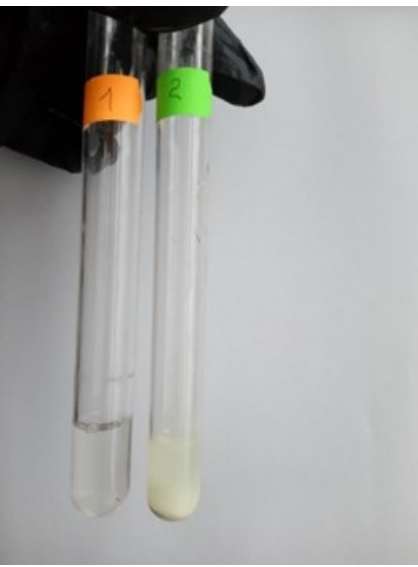
Рис.2.3. Дія калій йодиду на досліджуваний розчин (пробірка №1), і розчин аргентум нітрату (пробірка №2)
